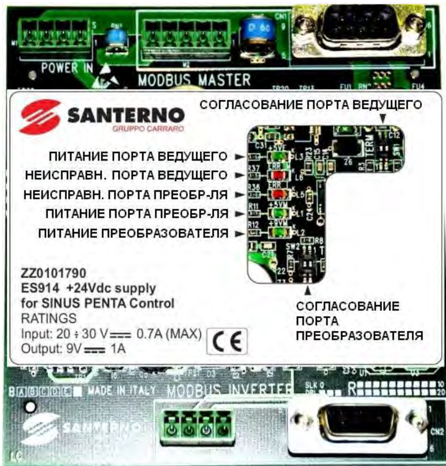
Рис. 174: Положение светодиодов и DIP-переключателей на плате ES914
