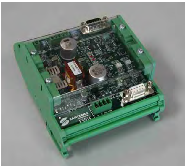
Рис. 171: Плата источника питания ES914
