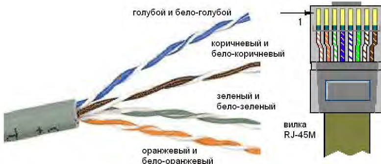
Рис. 134: Кабель категории 5 для сети Ethernet и стандартная цветовая раскладка
