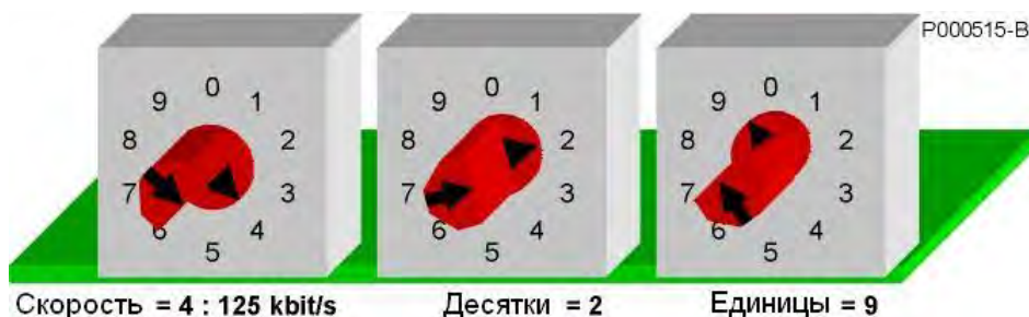
Рис. 132: Пример положения поворотных переключателей для выбора скорости обмена 125 кбит/с и адреса 29
