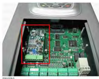
Рис. 116: Плата энкодера, установленная в преобразователь
