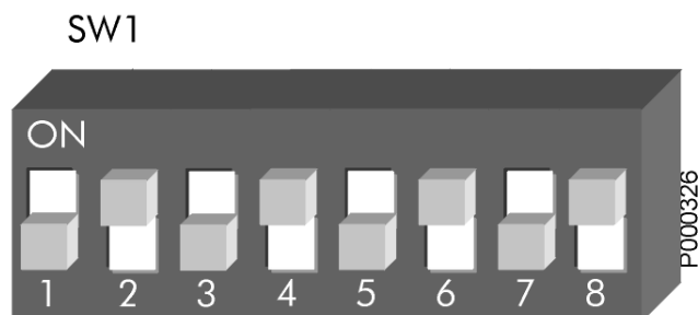
Рис. 181: Конфигурация переключателя SW1 для пятиканального режима.
