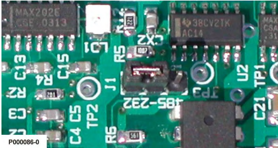
Рис. 121: Перемычка выбора RS232/RS485
