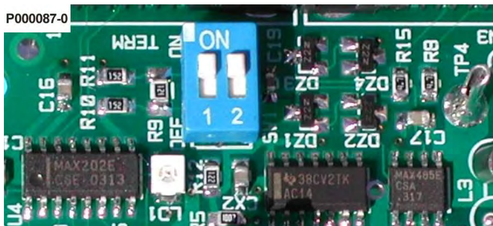
Рис. 122: Переключатели согласующего резистора интерфейса RS485
