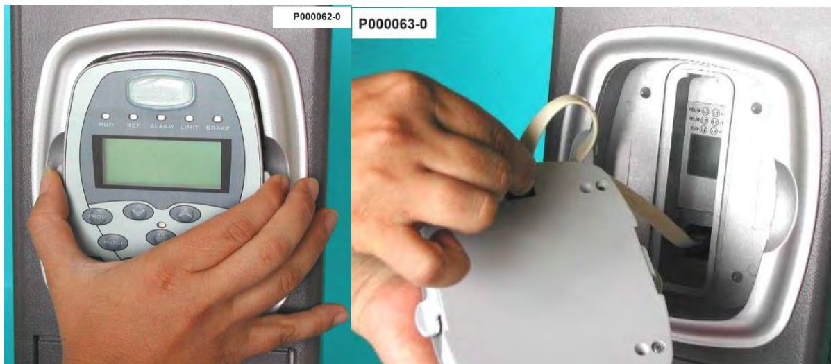
Рис. 61: Снятие пульта управления
