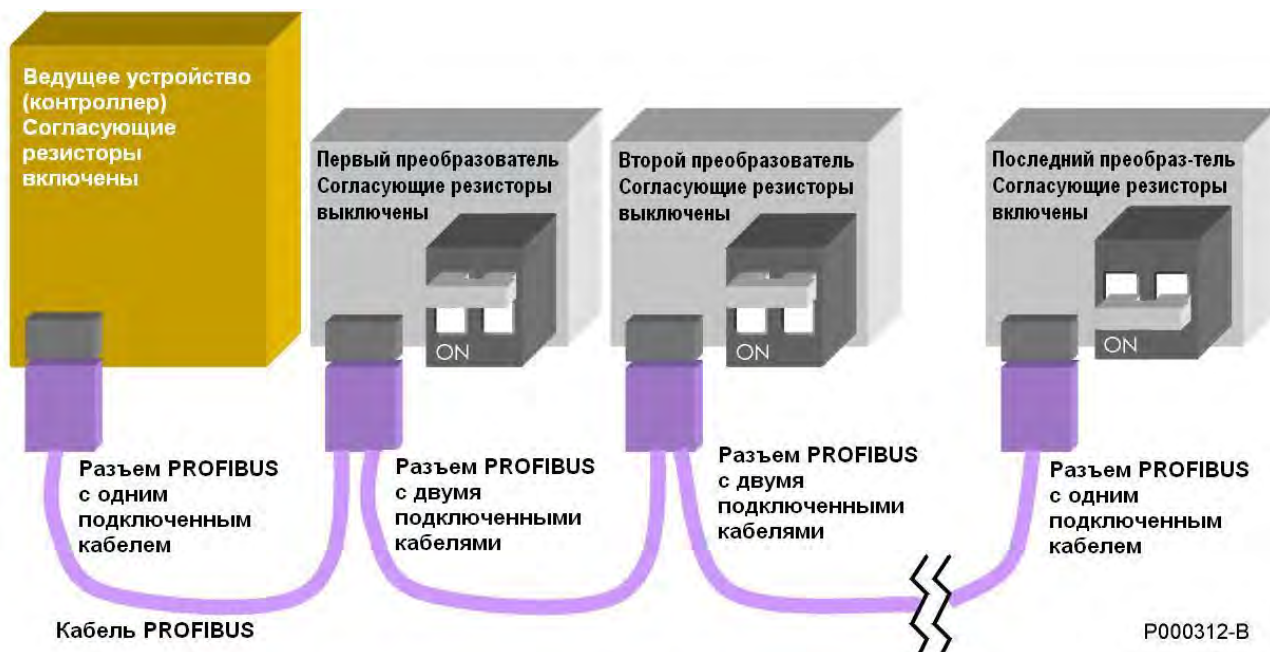
Рис. 127: Пример сети PROFIBUS (показано включение согласующих резисторов)
