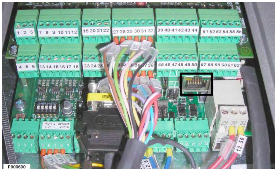
Рис. 154: Расположение порта Ethernet
