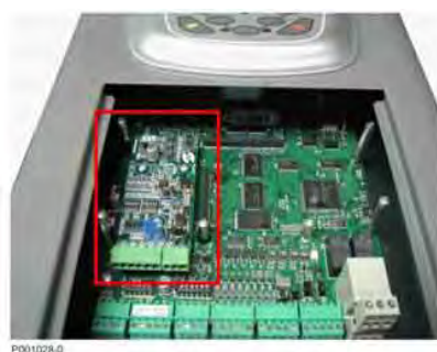
Рис. 107: Плата энкодера, установленная в преобразователь
