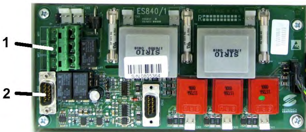
Рис. 27: Плата управления питанием ES840
