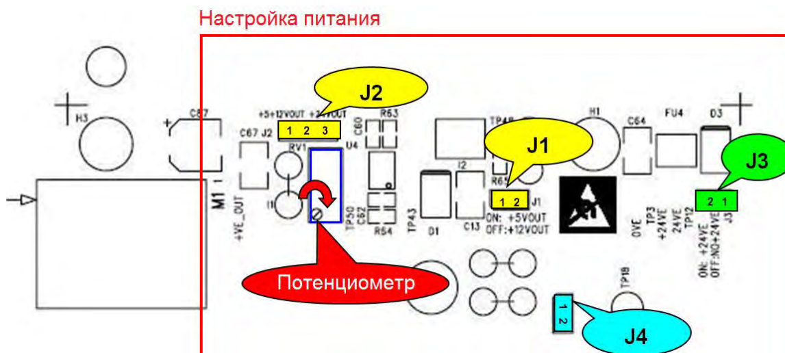
Рис. 190: Переключки и потенциометр настройки напряжения питания
