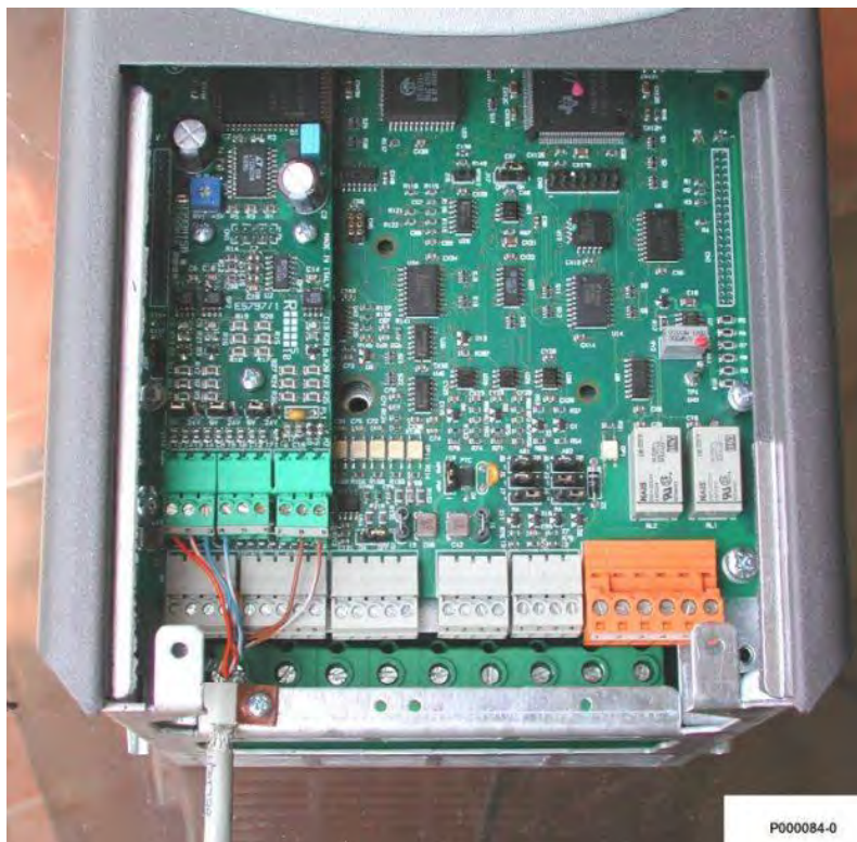
Рис. 113: Подключение кабеля энкодера
